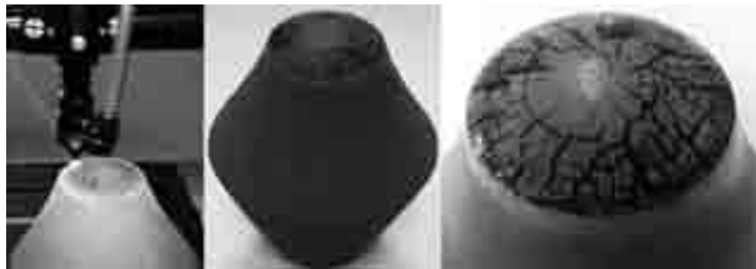
Şekil 11. Bisküvi Pişirimi Yapılmış Seramik Bünye Üzerine Lazer Aşındırma. “Denge”, Elle Şekillendirme, 1050°C, Füzyon Cam, 830°C, 38x42x21 cm. The 4rd International Ceramic Symposium, 2014.
